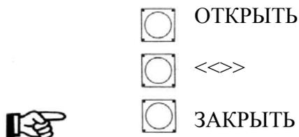
Немедленно после нажатия клавиши CLOSE (закрыть) будет выполнена серия маневров для определения пределов движения ворот. С помощью этих расстояний мы можем математически вычислить необходимую точку открытия “А” всего в нескольких сантиметрах от максимального открытия и расстояние “S” асинхронного смещения ворот приблизительно в 50 см от расстояния “0”.
