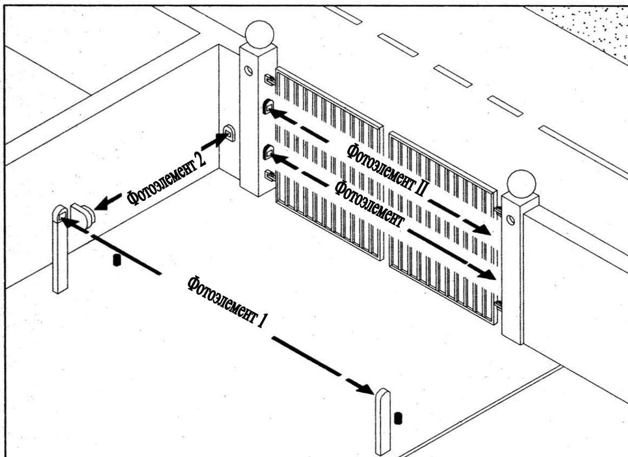
Когда несколько фотоэлементов установлены рядом, они могут мешать друг с другом. Для избежания этой проблемы фирмы Nice разработала систему под названием СИНХРОНИЗМ, которая работает на основе переменного тока.
