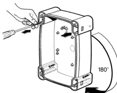
Вставьте два винта в верхние отверстия, продвигая их по направляющей, как показано на Рис.
